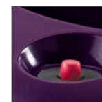
Valve témoin de la pression Surélevée quand la pression est élevée, elle s'abaisse quand la pression s'évacue naturellement, indiquant une ouverture sécuritaire*
